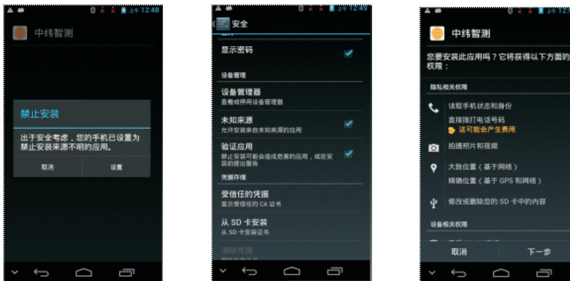
复制完毕后，在手簿的文件管理器中找到复制进去的APK文件，点击即可运行安装，如果有禁止安装的提示，则点击设置，勾选未知来源，再次安装，按照提示按下一步直至完成即可，安装完毕后，首次运行中纬智测手簿主界面会生成中纬智测的快捷方式。
