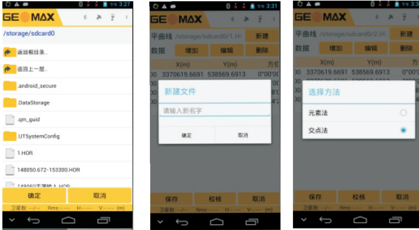
点击平曲线主界面中的新建后，弹出如图所示界面，选择好欲保存道路文件的目录后，按【确定】，弹出道路文件名输入，输入道路名后，再按【确定】后进入道路平曲线定义方法界面，选择完毕元素法或交点法后，返回到平曲线编辑主界面。
