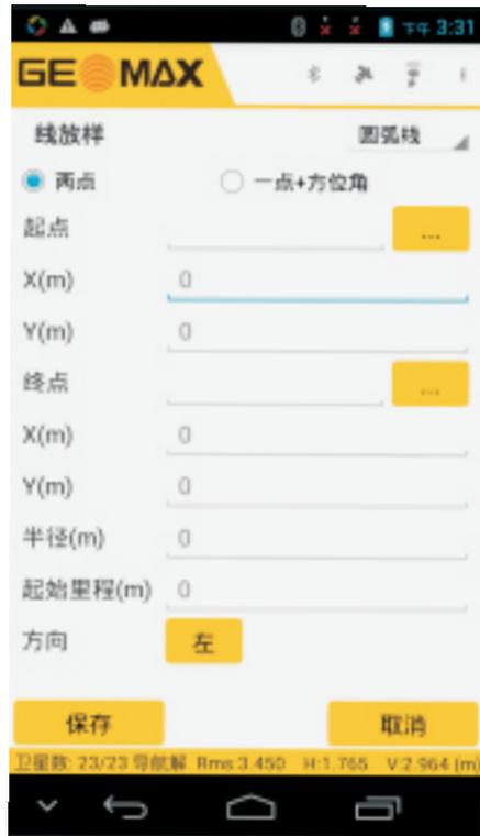
圆弧的定义方法有两种，可以依据两点或者点方位角定义。
