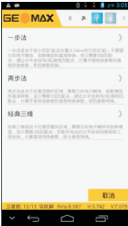
此功能用于将WGS84转换到用户当前所用的坐标系下来，提供了3种不同的转换方式，各方法的描述见方法下方的文字说明，用户可根据实际需要选用。
