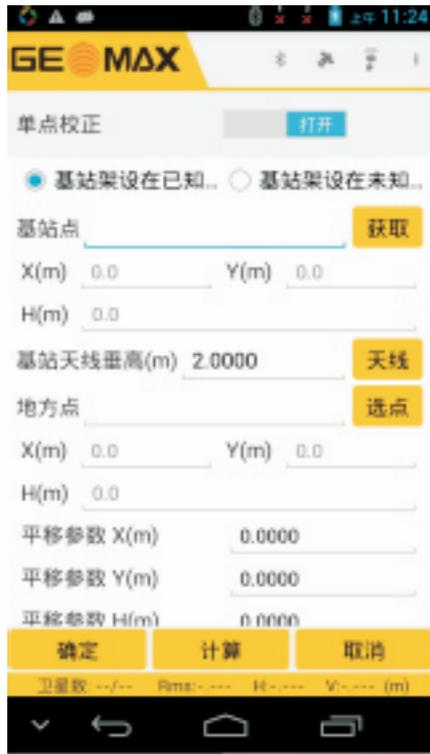
基站架设在已知点则说明基站架设在已知点，但是是用任意坐标启动的，通过修正基站点的坐标来转换坐标系到已有坐标系。
