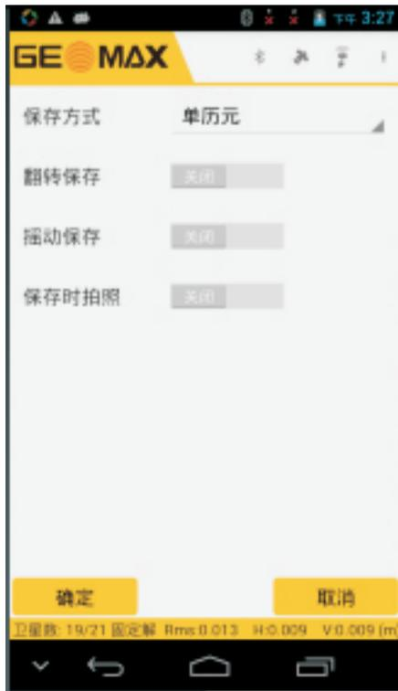
**【保存方式】**：选择测量点的保存条件，点击保存方式后面的区域可以下拉选择保存的方式
