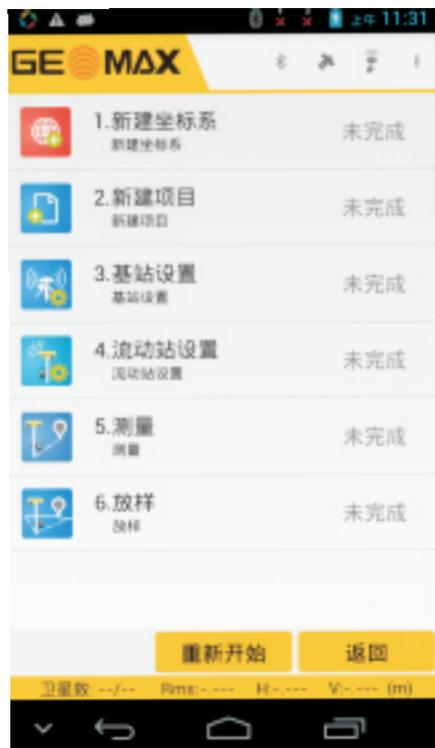
向导程序用于引导用户一步步完成测量中常用的设置，依照向导指示设置完成后，即可开始作业
