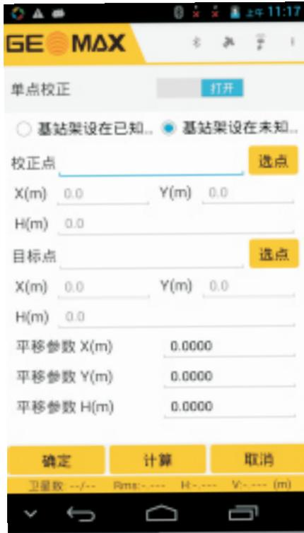
基站架设在未知点则说明基站任意架设，且架设的点没有已知坐标，通过移动站去校正一个点来转换坐标系到已有坐标系。
