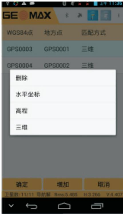
在成功增加完毕后，如果需要修改匹配方式，可以按住对应匹配点对，弹出高级菜单
