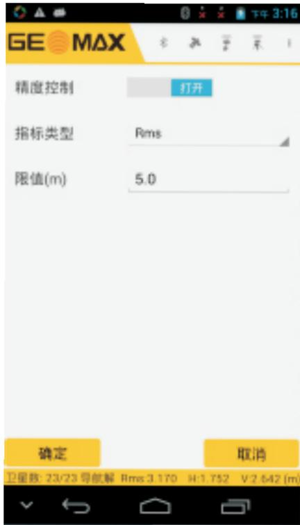
设置流动站测量过程中的精度控制，超过设置值的测量结果会提示不予保存。
