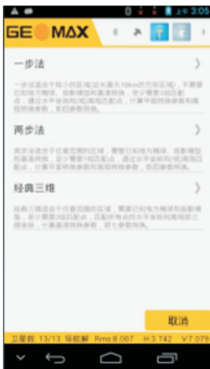
此功能用于将WGS84转换到用户当前所用的坐标系下来，提供了3种不同的转换方式，用户可根据实际需要选用。
