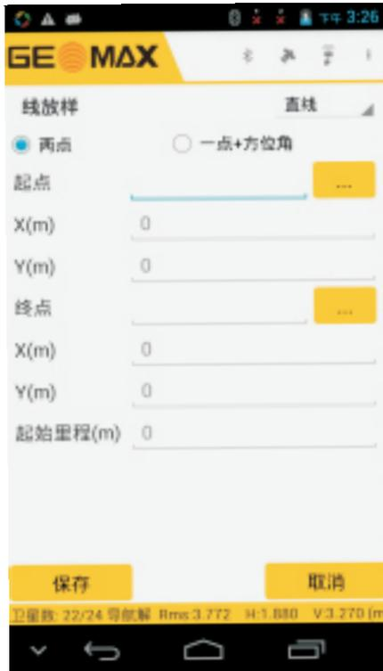
直线的定义方法有两种，可以依据两点或者点方位角定义。
