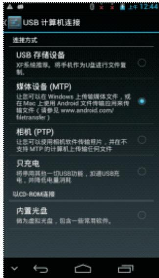
使用USB电缆连接上PC，在USB设置中选择连接方式为媒体设备（MTP），如果PC端为WINXP，则选择USB存储设备，连上设备后，将中纬智测安装包文件 (\*.apk) 复制到手机的任意目录。
