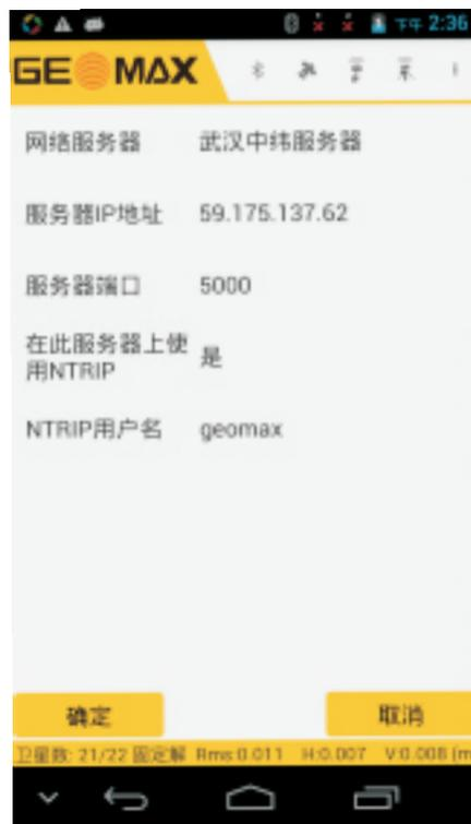
点击网络服务器可以选择服务器，默认内置了2个服务器，用户可以根据实际情况选择延迟最小的服务器。
