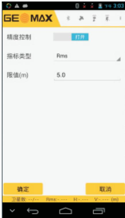
**【精度控制】**：选择打开/关闭来确定是否使用精度控制
