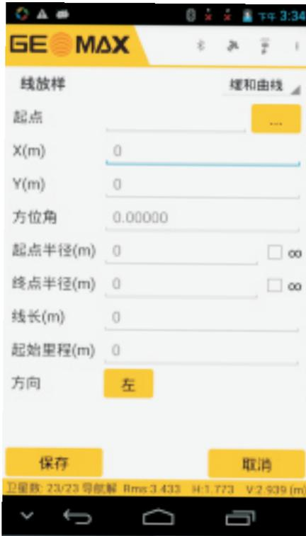
**【起点】**：缓和曲线的起点，点号可以输入，也可以测量或从数据库中选取，测量或选取的点的坐标会自动显示在下方。
