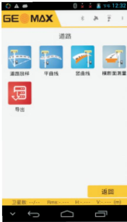
此程序用于道路的设计和放样，支持多种道路定义方式，显示和提示直观。主要功能分为五大类，分别是道路放样、平曲线、竖曲线、横断面测量、导出。
