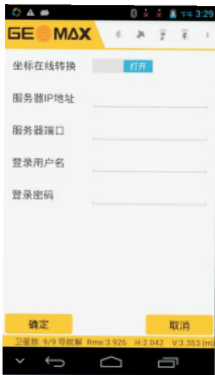
此功能用于在某些参考站不提供转换参数，需要用户将测得的坐标传输到指定服务器在线转换后再传回。
