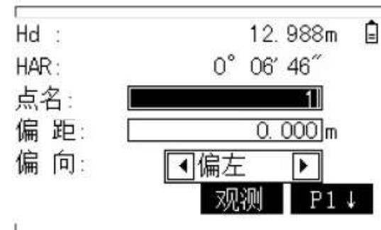
③照准测量点，按F3[观测]。测距完毕，按F1[确定]，仪器同时记录测量点。
