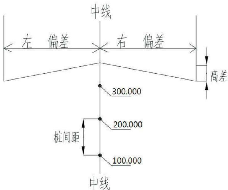
除了直接使用坐标数据文件进行放样，还可以手动输入桩号和偏差，仪器根据输入的要素，计算对应的坐标，进行放样。在[选择放样方式]界面，选择2[输入桩号和偏差]进入。
