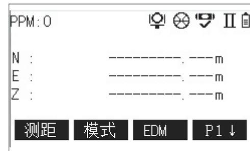
通过F4可以切换软功能，在第二页软功能，可以设置镜高、仪高、测站坐标。
