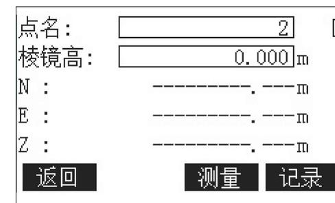
点号可以手动更改，按F3[测量]测量目标点坐标并显示在屏幕上，按F4[记录]将坐标保存至当前作业，点号自动加1。
