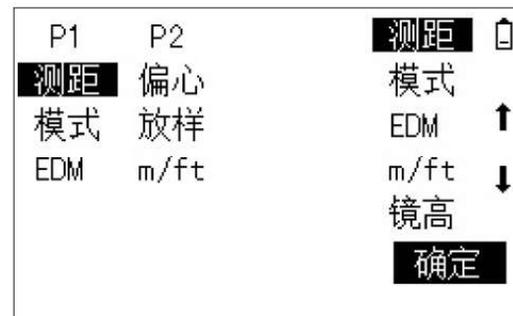
此时左侧光标位于P1的F1 [测距]上，说明可以设置第1页的F1软按键功能。按上下导航键，右侧光标上下移动，任意选择一项，例如“镜高”。按ENT键，左侧光标处变成[镜高]，说明P1的F1功能由“测距”变成“镜高”。按左右导航键，左侧光标向下移动，即可设置F2软按键的功能。依次可以设置P1、P2两页F1—F3软按键的功能。F4是翻页键不可设置。设置完成后，按F4[确定]，保存设置。
