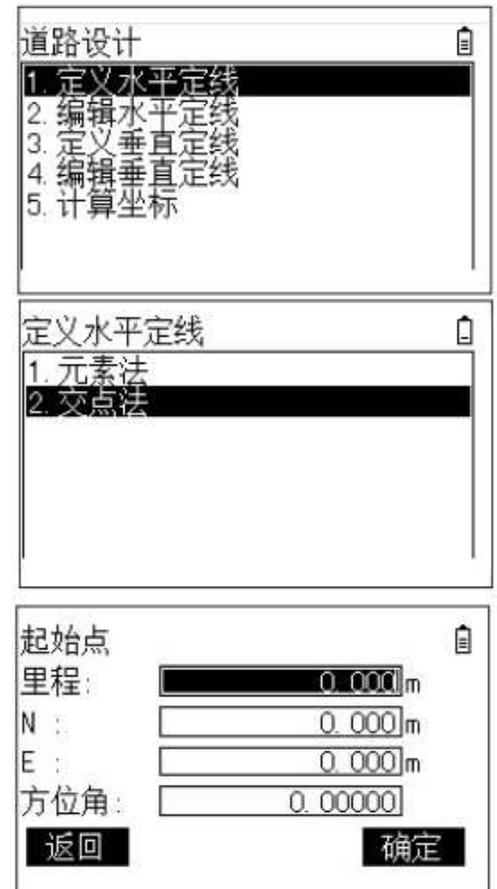
起始点输入完成后，按F4[确定]，进入[已输入元素]界面。该界面显示当前定线数据末端的桩号、该桩号处切线的方位角和坐标，还有创建新线型的软功能键。有直线、圆曲线、缓和曲线这三种线型。
