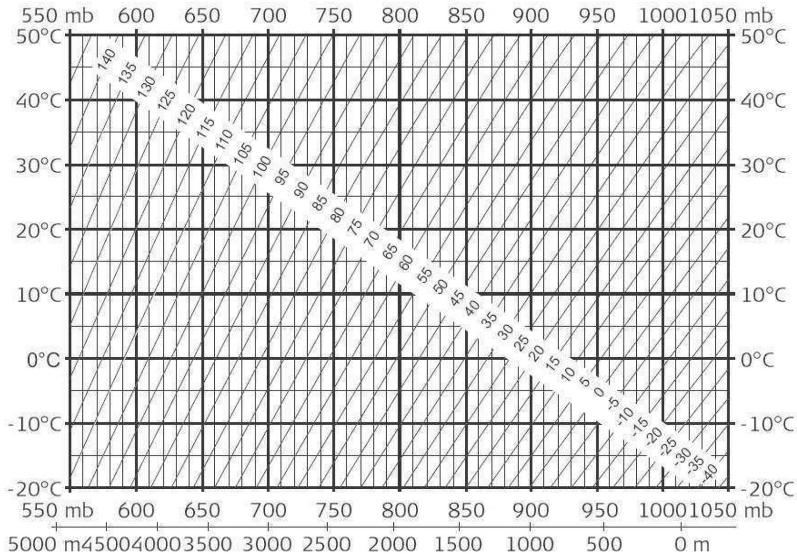
在相对湿度等于60%的条件下，根据气温[°F]、气压[inch Hg]和高程[ft]计算大气改正如下：
