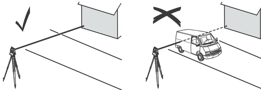
当启动距离测量时,EDM会对光路上的物体进行测距。如果此时在光路上有临时障碍物(如通过的汽车,或大雨、雪或是弥漫着雾)。EDM所测量的距离是到最近障碍物的距离。
