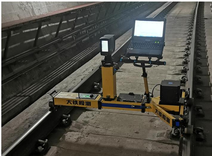
**简介：**三维激光扫描仪与惯性导航系统结合。
