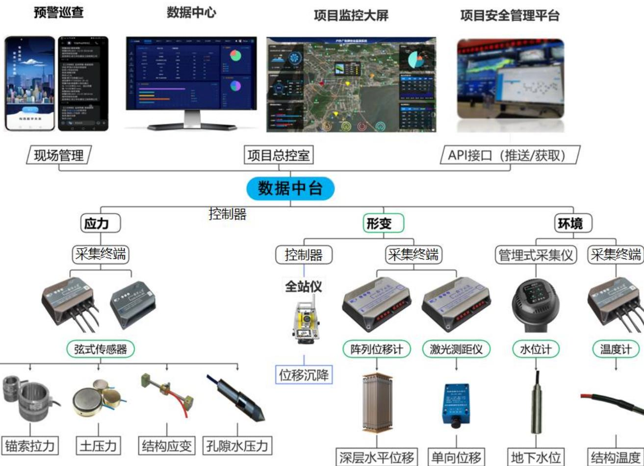
基坑工程支护结构及环境自动化监测内容及系统架构
