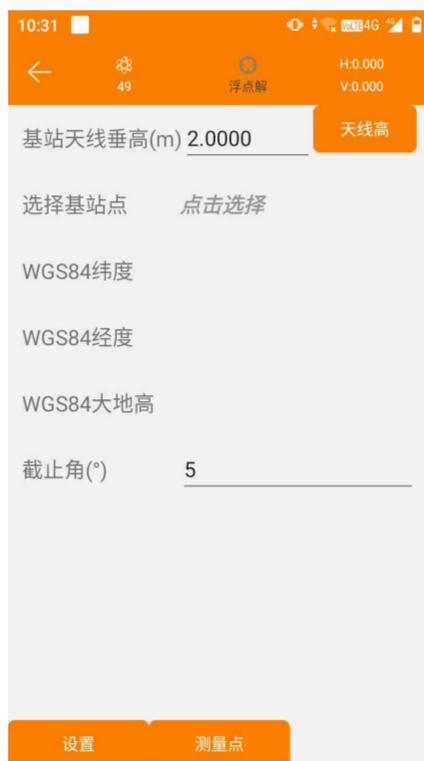
【基站天线高】：输入基站点的天线架设高度
