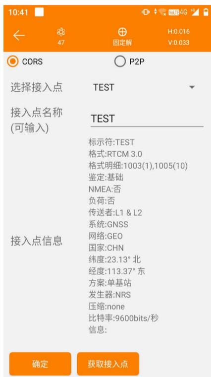
【CORS】：选择CORS，自动从服务器获取节点列表，选择一个节点，点击确定即可开始连接
