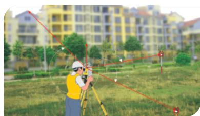
自由设站可计算出测站三维坐标及水平度盘方向，可以使用多达5个已知点作为后视点参与计算，同时支持盘左盘右双面观测，极大地提高了准确性。
