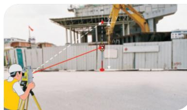
悬高测量主要用于测定建筑物的净空高以及电力线高度等，可以通过先测量放置于目标点正下方的基点，再瞄准目标点的方法计算得到。
