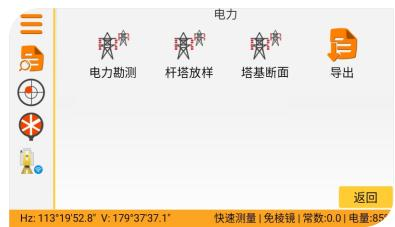
电力测量程序，通过专业的程序测量，实现安全、高效、精确地获取架空线路的空间数据，大幅提升电力工程勘测、施工与运维的效率和安全性。
