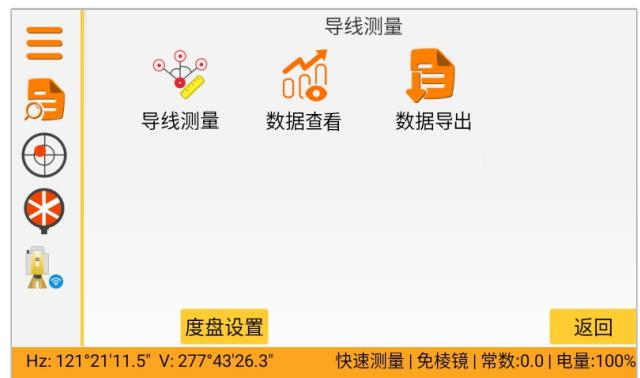
导线测量功能可实时进行平差后处理，自动记录多站三维坐标并形成闭合差报告，保障控制网整体平差质量及基准可靠性。
