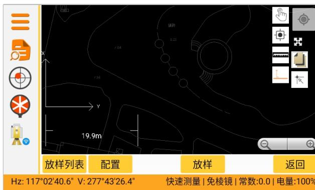
ZOOM45的CAD放样功能简单易上手，可直接导入DXF/DWG格式设计数据，自动匹配坐标系，实时显示三维偏差，保障毫米级精准定位。
