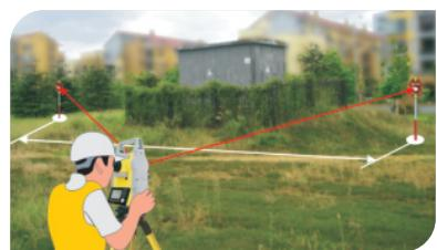
对边测量程序用来测定两点间的距离、坡度、方位角及高差。所测对边可以是连续的折线和源于一个中心点的射线。在测量过程中，最后两点可以即时进行对边检查。
